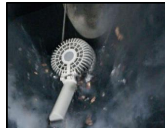
リチウムイオンバッテリーの破裂
