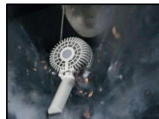
リチウムイオンバッテリーの破裂
